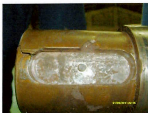
FIG. 3, 4 e 5 - Aspecto da região do alojamento de chaveta no colo do eixo de apoio do 6º Cilindro do Trem 4 – Observa-se a área de propagação da trinca nucleada na raiz do alojamento de chaveta. (Fonte: Inspeção visual realizada na Oficina Central em 17/10/2011).
