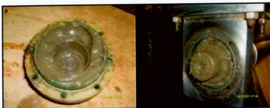
Figura 31- Mancal e tampa revisados em bancada após 21 dias de trabalho
