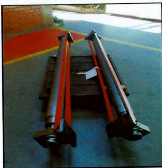
Figura 30- Mancais e rolos revisados em oficina para serem montados no dipping
