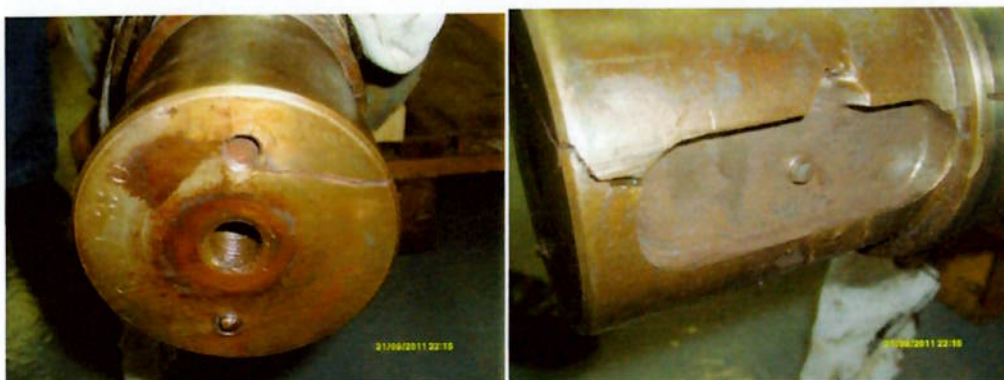
FIG. 1 e 2 - Aspecto da região de fratura ocorrida no eixo de apoio do 5º Cilindro do Trem 4 – Observa-se a área de propagação da trinca até a ruptura frágil. (Fonte: Inspeção visual realizada na Oficina Central em 17/10/2011).
