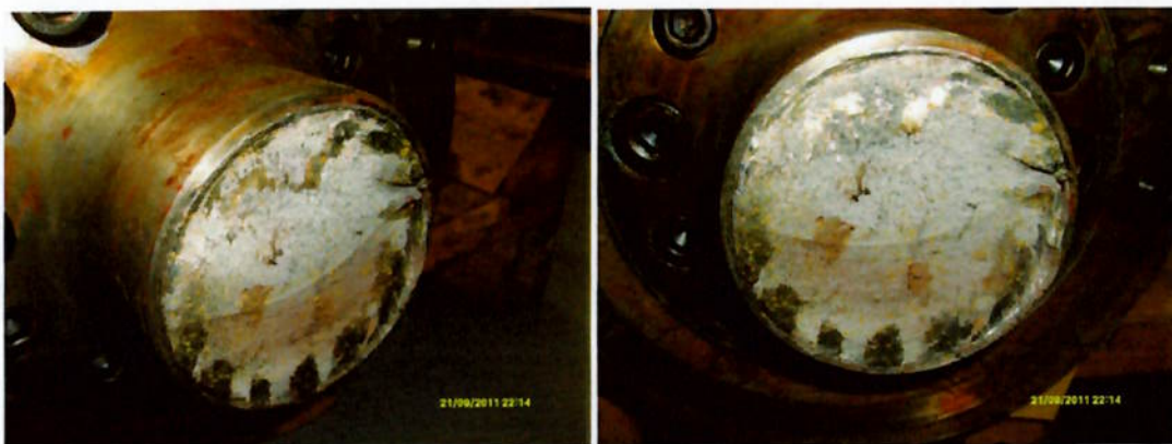
FIG. 1 e 2 - Aspecto da região de fratura ocorrida no eixo de apoio do 5º Cilindro do Trem 4 – Observa-se a área de propagação da trinca até a ruptura frágil. (Fonte: Inspeção visual realizada na Oficina Central em 17/10/2011).
