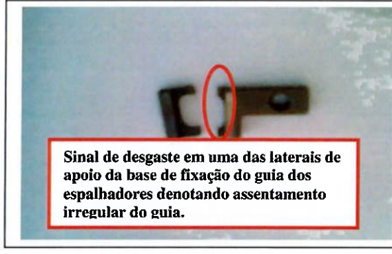
Fig. - 6 - Base de apoio do guia de ajuste do espalhador da máquina manual.
